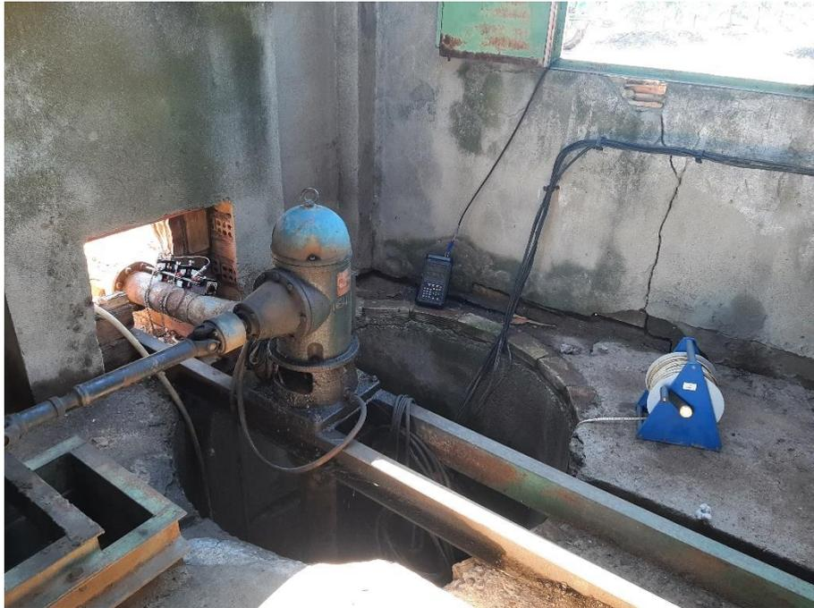
**Medida de caudal y nivel dinámico de agua del pozo**
