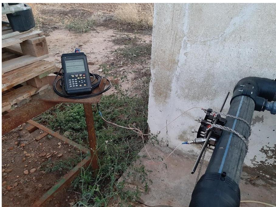
Detalle instalación caudalímetro en colector impulsión
